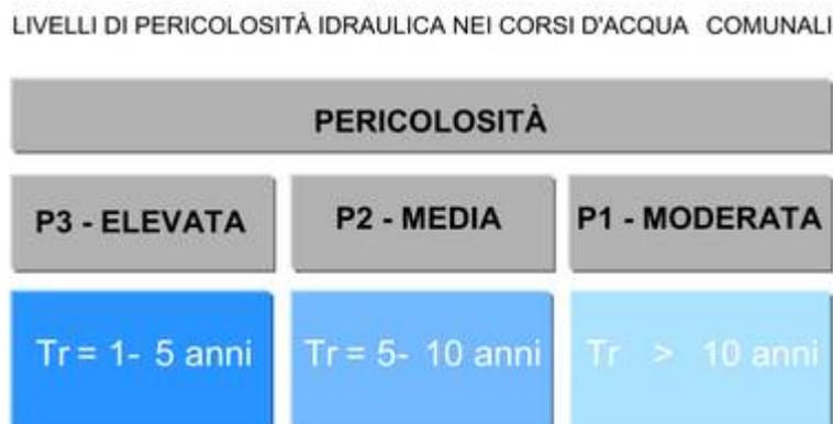
Figura 12 - Classi di pericolosità idraulica
